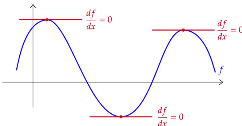
Figura 34: Recordando a interpretação da derivada enquanto coeficiente angular da reta tangente ao gráfico da função em um dado ponto, podemos perceber que nos pontos de máximo e mínimo da função a reta tangente é horizontal, ou seja, possui coeficiente angular nulo. Dessa forma, dada uma função, podemos determinar os seus pontos de máximo e mínimo resolvendo a equação  $\frac{df}{dx} = 0$ .
